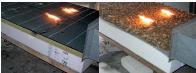
Příklady zkoušek skladeb vhodných pro požárně nebezpečné prostory s klasifikací  $B_{ROOF}(t3)$ .
