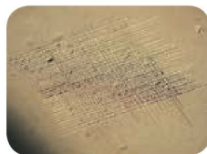
Vytvoříme mřížku cca 2 x 2 mm na prostoru cca 10 x 10 cm. V případě, že cca 80 % stěrka-vačí hmoty zůstává na místě, není třeba nové stěrky.
