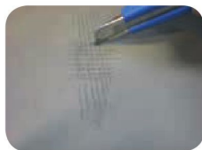
Pevnost stěrky posuzujeme tzv. vrypky ocelovým trnem nebo nožem.
