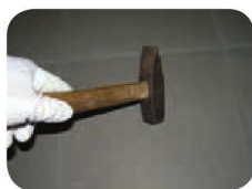
Poklepem na každou dlaždičku zjistíme její stabilitu.
